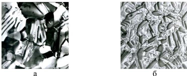
Рис. 3. Микроструктура гетерогенной области сплавов системы Ni–Cr,  $\times 36000$ :
